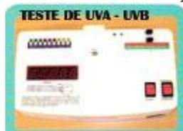
Aparelho para medir o nível de proteção aos raios ultra violeta (UV, UVA e UVB) de uma lente. É um dispositivo opto-eletrônico constituído de fonte e detector de radiação ultravioleta com componentes eletrônicos para o processamento digital e visualização dos resultados da medida da proteção aos raios Ultra Violeta das lentes no display LCD. A fonte utilizada para emitir radiação UVA e UVB é uma lâmpada fluorescente negra.
