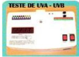
Aparelho para medir o nível de proteção aos raios ultravioleta (UV, UVA e UVB) de uma lente. É um dispositivo opto-eletrônico constituído de fonte e detector de radiação ultravioleta com componentes eletrônicos para o processamento digital e visualização dos resultados da medida da proteção aos raios Ultra Violeta das lentes no display LCD. A fonte utilizada para emitir radiação UVA e UVB é uma lâmpada fluorescente negra.
