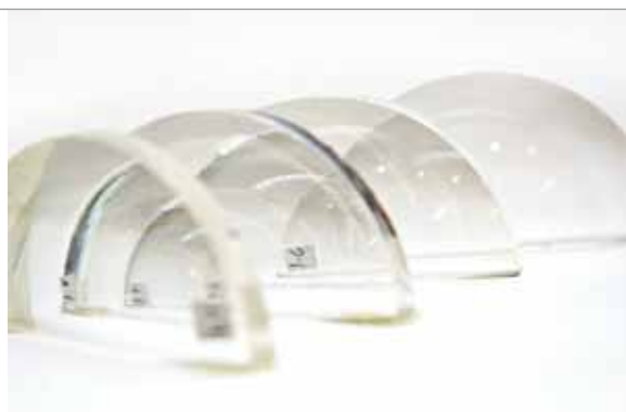
Figura 29 Mostruário de espessura de lentes oftálmicas por índice de refração
