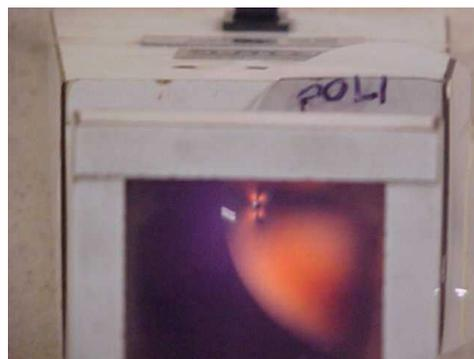
No caso da figura à esquerda temos um exemplo de polariscópio e à direita o aspecto colorido da lente é característico do policarbonato que é produzido através de um resfriamento muito rápido e que gera o acumulo de tensões, além disso, observamos um furo mal feito que acabou produzindo mais tensões no material.
